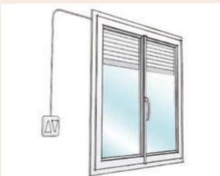
Filaire avec arrêt sur obstacle et interrupteur au mur.
